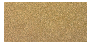
Výsledek zkoušky po 360 hodinách vystavení roztoku chloridu sodného
